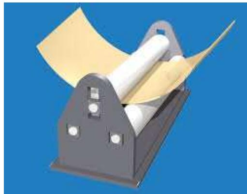
**Abbildung 11: Prinzip 3-Walzen-Biegemaschine (Wikipedia)**
