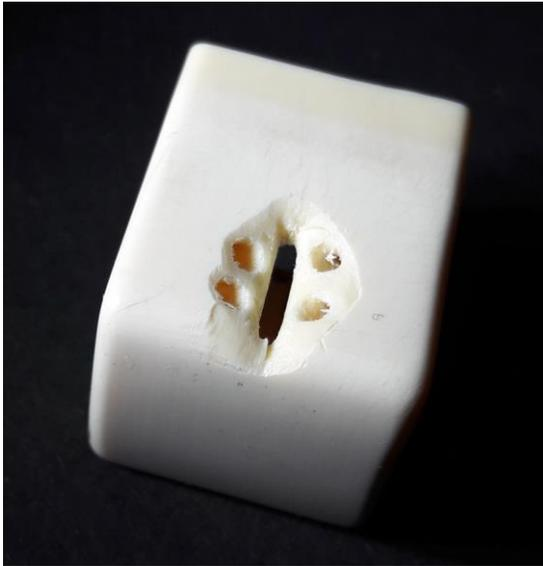
ergab. Außerdem sorgte ich für Löcher zu den beiden rechts und links oben in der Taste befindlichen dreieckigen Hohlräumen, um die Reparaturmasse bis in diese Zwischenräume durchschieben zu können. Es war darauf zu achten, dass die Masse nicht in den länglichen Schlitz in der Tastenmitte eindringen darf, denn hier soll ja später wieder der Hebel zur Taste eingeführt werden.
